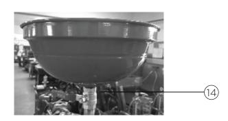
Attention : avant d'ouvrir la valve, vérifier le réservoir. S'il y a de l'air sous pression à l'intérieur du réservoir, pour votre sécurité, vous devez le décharger.
